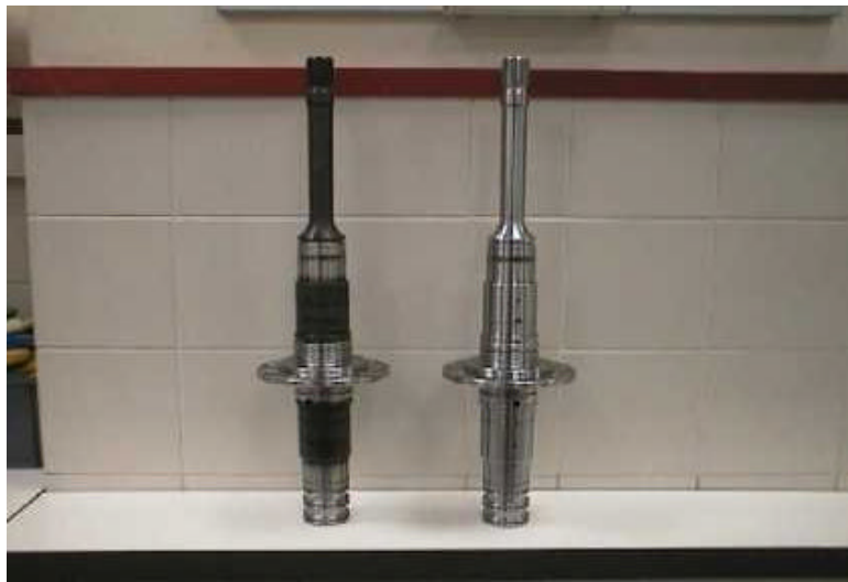
Figure 45 : cette photo montre la pièce avant traitement thermique (pièce de droite) et après (pièce de gauche)
