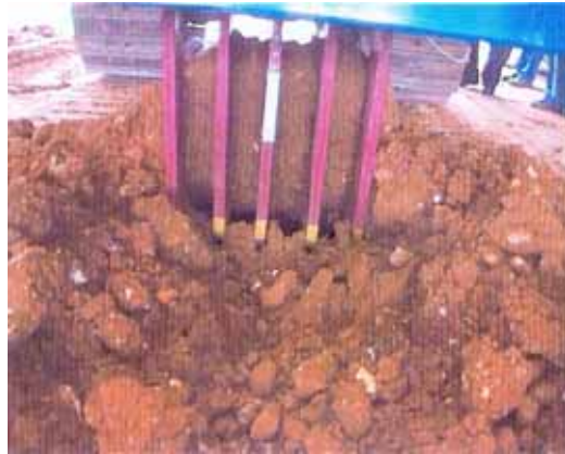
Figure 5.58 : Dispositif DIDEMEX échelle 1 (CER-Rouen, [96]) sur de l'argile. Etrave 90°, 5 dents (3cm/30cm) à 45° en râteau, espace inter-dent 17cm.
