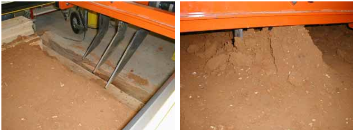
Figure 5.55 : Configuration trois dents alignée échelle 1/3. Etrave 65^\circ , dents (1cm large/10cm profondeur) à 45^\circ , espace interdent 14cm. Sol bigradué avec 15% de fines (LERMES, [69]).
