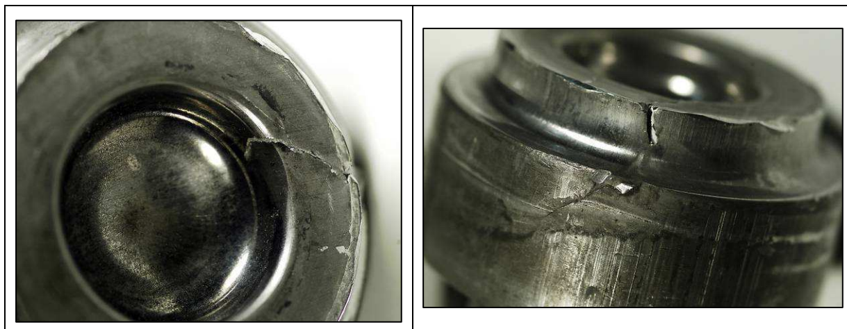
Figure 5.28 : Exemple d'une pièce fissurée avec la nouvelle gamme
