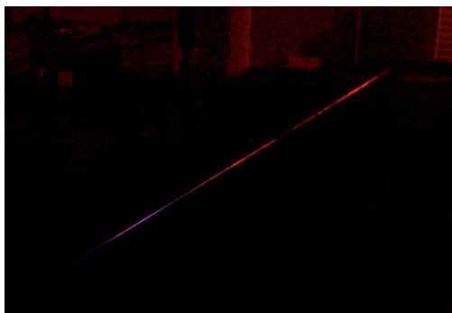
FIG. 2.2 - Photo d'un filament produit en laboratoire en focalisant un faisceau de 1cm de diamètre avec une lentille de focale f = 3 m. La couleur bleuté correspond à l'émission des molécules d'azote ionisées, tandis que le rouge provient de la diffraction du continuum dans le plasma.
