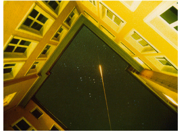
FIG. 1.1 - À gauche : Photo d'un filament de quelques dizaines de cm produit dans l'air. La lumière bleutée correspond aux raies d'émission de l'azote dans le plasma. En sortie de filament le faisceau devient visible (de couleur rouge) en raison de l'élargissement du spectre de l'impulsion par auto-modulation de phase. À droite : Photo d'un filament de 4 TW produit dans le ciel de Iéna à l'aide du laser TéraMobile (photo Projet TéraMobile). Le faisceau de lumière correspond à la diffusion du continuum de lumière blanche produit dans le filament.
