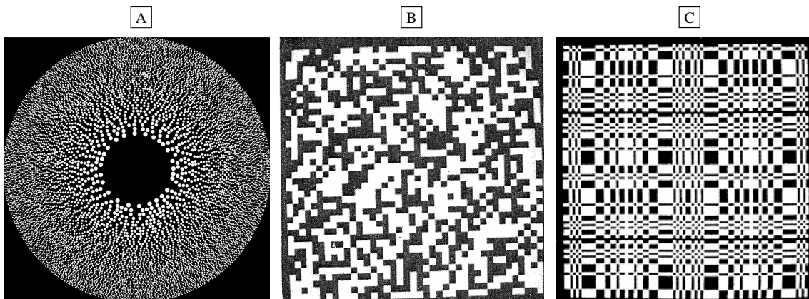
FIG. 2.31 – Illustration de différentes manières de disposer une multitude de sténopés : (A) tamis à photon [109], (B) masque codé composé d'une répartition aléatoire et non redondante de sténopés [113], (C) tableau uniformément redondant [113, 117].
