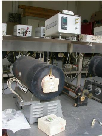
Figure 3.11 : Four tubulaire utilisé pour le vieillissement thermique des échantillons
