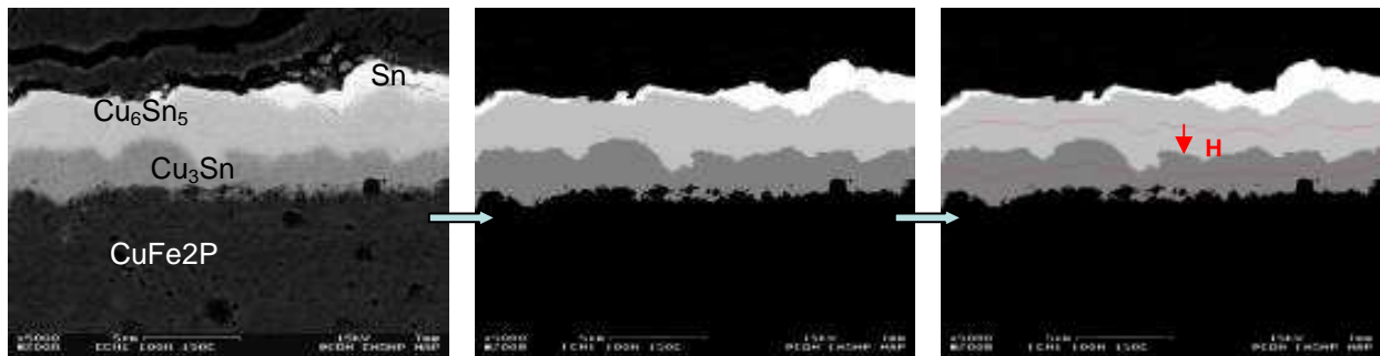
a) b) c) Figure 3.17 : Principe de la mesure d'épaisseur : a) image avant traitement, b) image après conversion en niveaux de gris, c) image après mesure d'épaisseur (demi-distances représentées en rouge)
