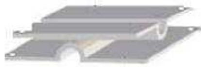
Figure 4.1 : Mise en forme de feuillard de cuivre revêtu d'étain par emboutissage. On obtient un contact électrique dont l'aire de contact est circulaire en croisant les deux barreaux à 90°
