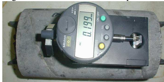
Figure 5-5 Mesure d'expansion à l'aide d'un distancemètre
