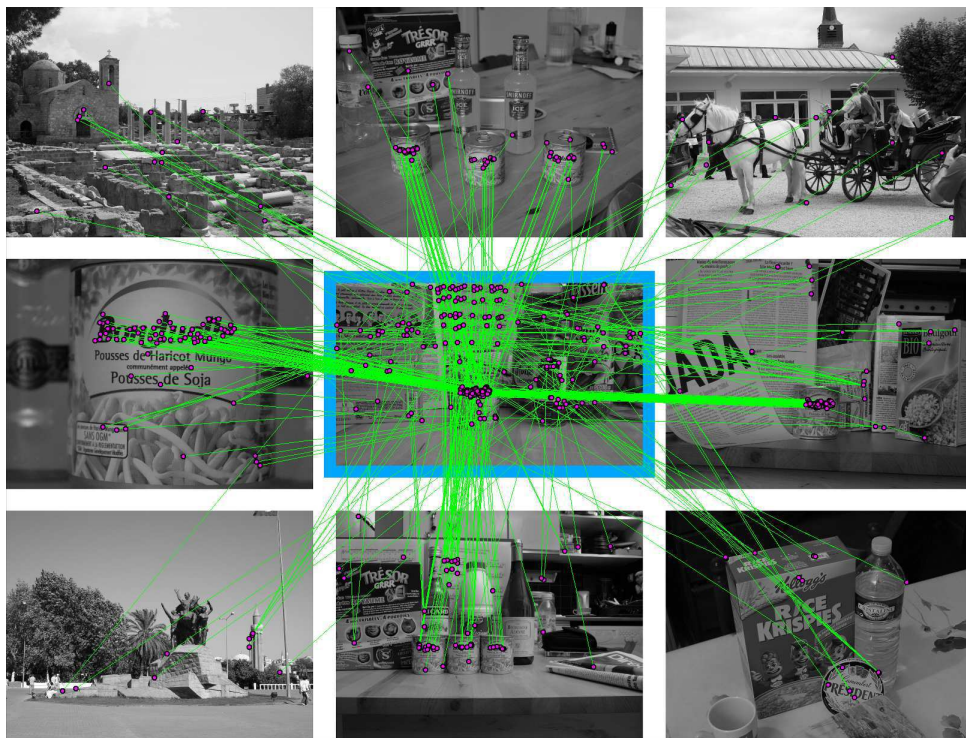
(a) Distance euclidienne et critère de mise en correspondance NN-DR avec r = 0.8
