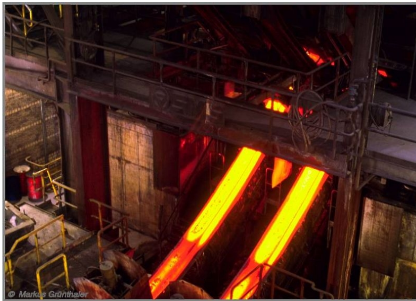
FIG. 9 – Refroidissement secondaire simultané de deux brames [Finster, 2007].
