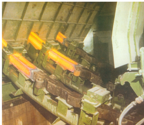
FIG. 10 – L'initialisation du procédé de coulée continue est réalisée à l'aide d'un mannequin. [PLD, 2007].
