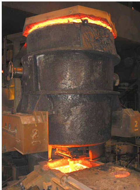
FIG. 5 – Poche de coulée alimentant un répartiteur [NZL Steel, 2007].
