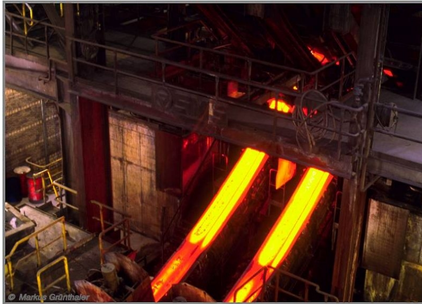
FIG. 9 – Refroidissement secondaire simultané de deux brames [Finster, 2007].
