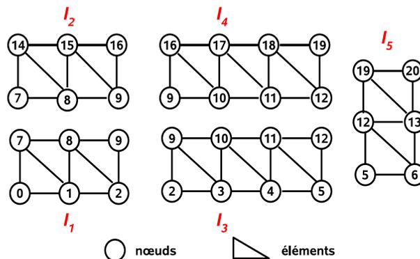
FIG. 1.6 – Partition d'un maillage éléments finis
