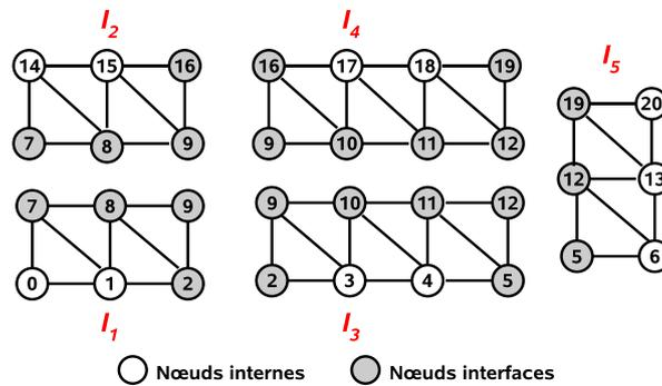
FIG. 1.7 – Nœuds internes et interfaces des sous-domaines.
