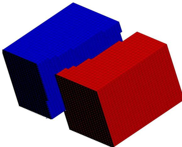
FIG. 3.13 – Découpage du cube de dimension  $(1, 1, 1)$  en 2 sous-domaines.
