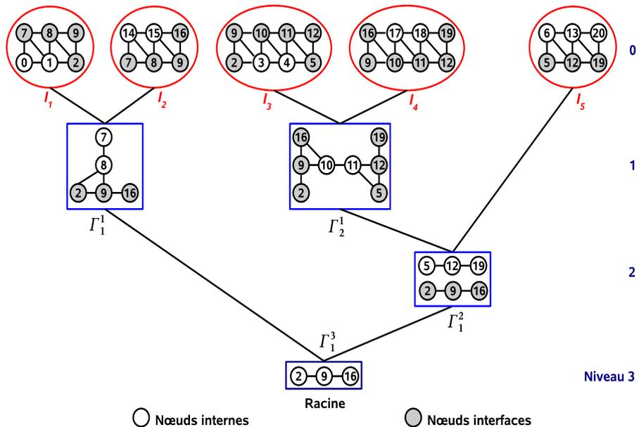
FIG. 1.8 – Super-arbre d'élimination et dépendances : 1<sup>re</sup> approche.
