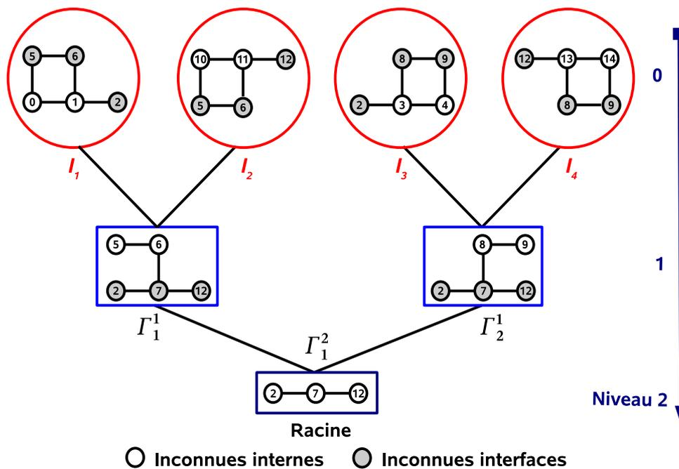
FIG. 1.9 – Super-arbre d'élimination et dépendances : 2<sup>e</sup> approche.
