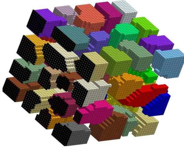
FIG. 3.6 – Découpage du problème de taille 285099 en 50 sous-domaines .
