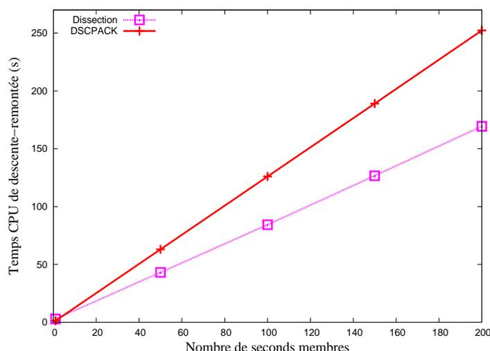
FIG. 1.18 – Comparaison des temps CPU de descente-remontée.
