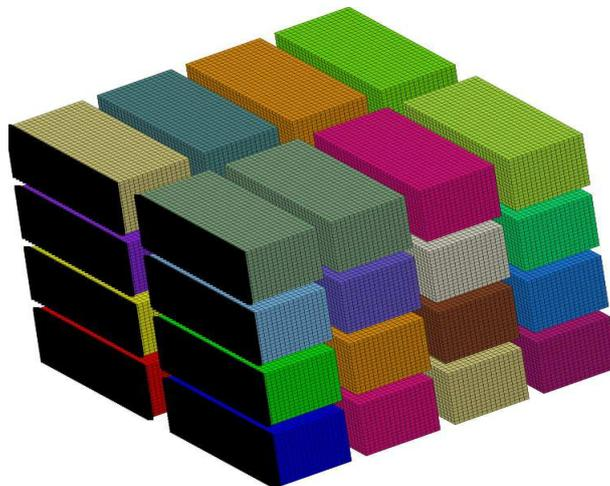
FIG. 3.8 – Découpage du problème de taille 3371544 en 32 sous-domaines .
