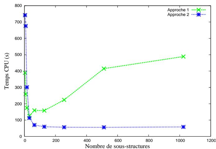
FIG. 1.15 – Temps CPU d'exécution : problème de 107811 ddl.
