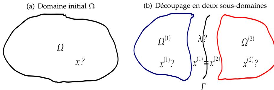
FIG. 3.1 – Principe de la méthode FETI.
