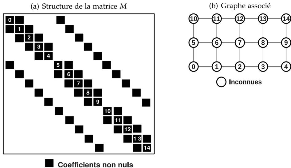
FIG. 1.3 – Exemple de système linéaire creux.
