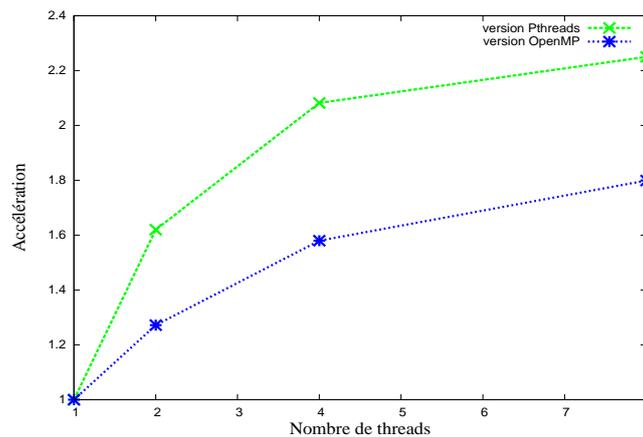
FIG. 2.21 – Accélération sur l'exécution du complément de Schur.
