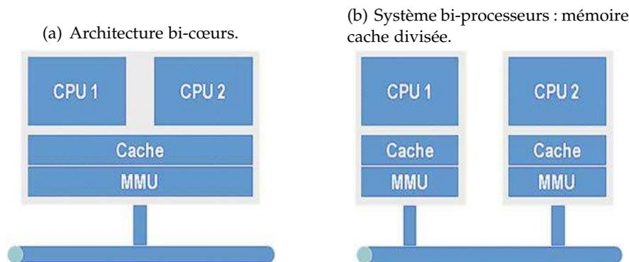
FIG. 2.5 – Exemples d'architectures multi-cœurs et multi-processeurs.
