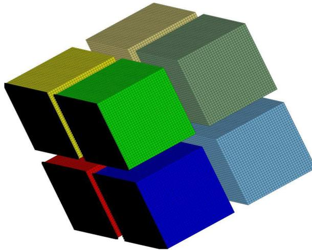
FIG. 3.7 – Découpage du problème de taille 3371544 en 8 sous-domaines .
