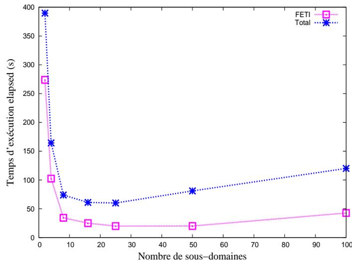
FIG. 3.9 – Version existante de FETI : efficacité dans ZéBuLon.
