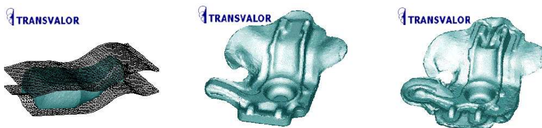
FIG. 6 – Simulation numérique du forgeage d'un pivot de fusée par Forge3 , préforme, configuration intermédiaire et configuration finale
