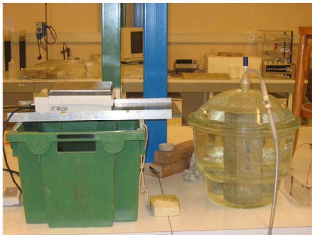
**Figure 4 : Balance de précision et bac à eau pour la pesée hydrostatique**
