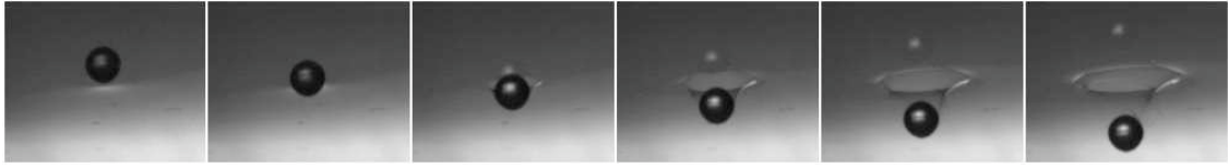
FIG. 4.18 – Chronophotographie de l'éclatement d'un film provoqué par l'impact d'une bille de verre de 4 mm de diamètre, lancée à 2,6 m/s. Intervalle entre deux images consécutives : 3 ms.
