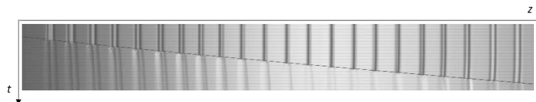
FIG. 5.7 – Diagramme spatio-temporel représentant (en noir) la position d'une bille hydrophobe de 1,6 mm de diamètre dans une mousse bambou. La bille progresse de la gauche vers la droite, en faisant éclater les films. On remarque que sa progression est quasiment linéaire en fonction du temps : lorsque les films ne cicatrisent pas, le freinage est impossible.
