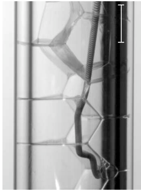
FIG. 5.10 – Trajectoire d’une bille d’aluminium dans une mousse désordonnée, obtenue par superposition des images de la vidéo. La barre blanche représente 1 cm.
