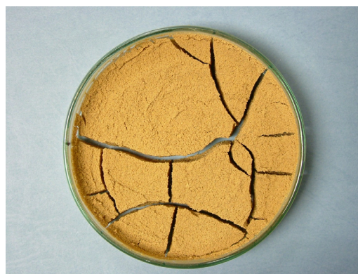
Figure 2.4. Comresse contenant de la bentonite (formulation 1:5:6 Bentonite:Billes de Verre:Eau) montrant un fort retrait au séchage.
