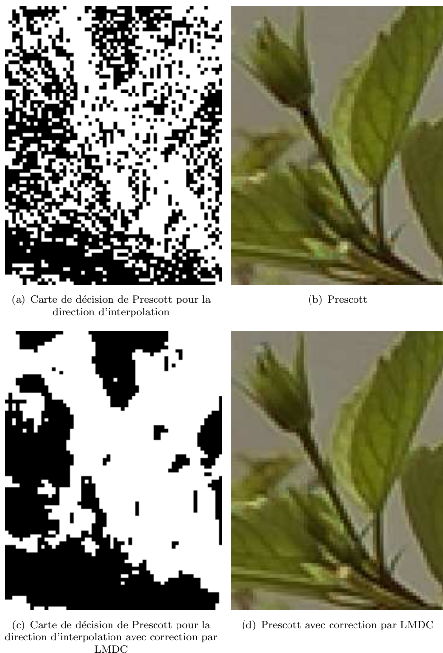
FIGURE 5.7 – Exemple de réductions des artefacts avec la méthode de LMDC avec l'algorithme de Hamilton [9].
