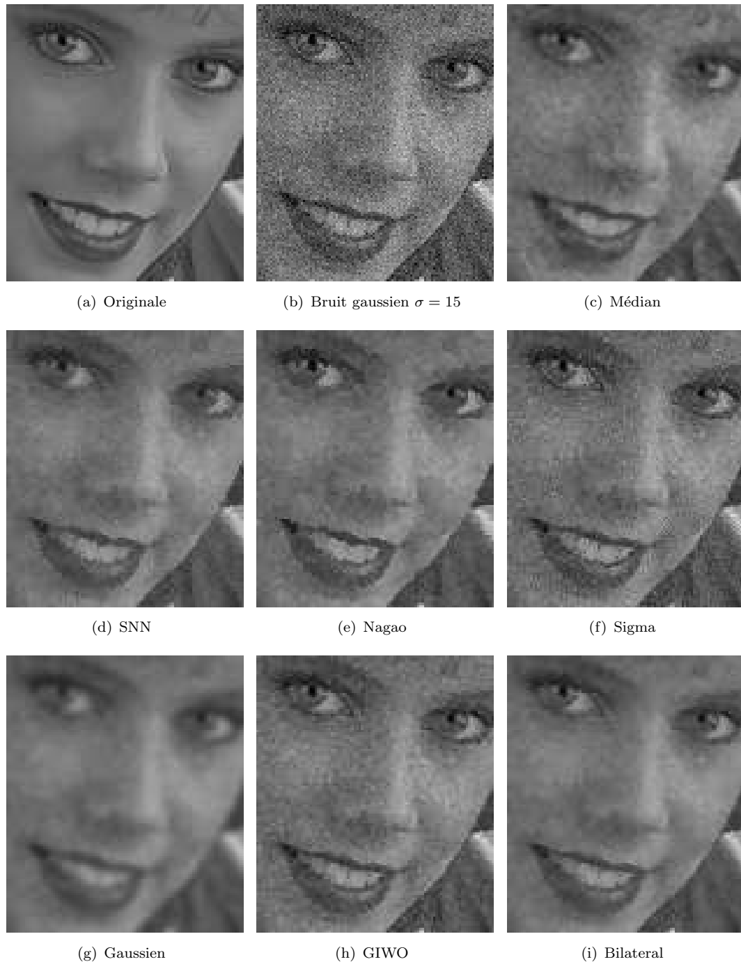
FIGURE 6.4 – Comparaison des qualités d'images produites par les différents filtres à voisinage local étudiés.
