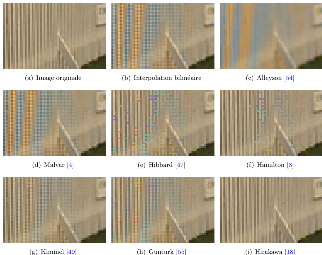
FIGURE 4.14 – Comparaison des qualités visuelles des différents algorithmes de dématriçage étudiés.
