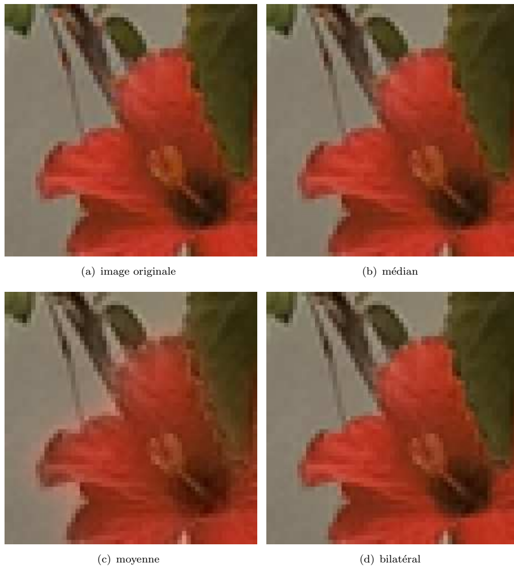
FIGURE 5.9 – Résultats obtenus en appliquant des filtres médian, moyenne et bilatéral sur les différences des plans vert/rouge et vert/bleu.
