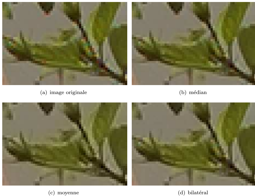
FIGURE 5.8 – Résultats obtenus en appliquant des filtres médian, moyenne et bilatéral sur les différences des plans vert/rouge et vert/bleu.
