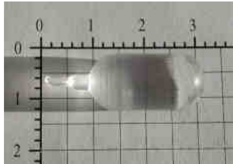
Figure 1.10: boule de fluorine dopée ytterbium obtenue par la méthode de croissance de Bridgman-Stockbarger par le CIMAP
