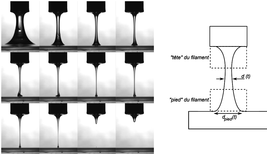
FIGURE 6.15 – À gauche : chronophotographie d'une expérience de drainage, avec D = 13 \text{ mm} , \eta = 12 \text{ Pa} \cdot \text{s} , L = 22 \text{ mm} . L'intervalle entre deux images vaut 1,33 s. À droite : schéma du filament en train de drainer.
