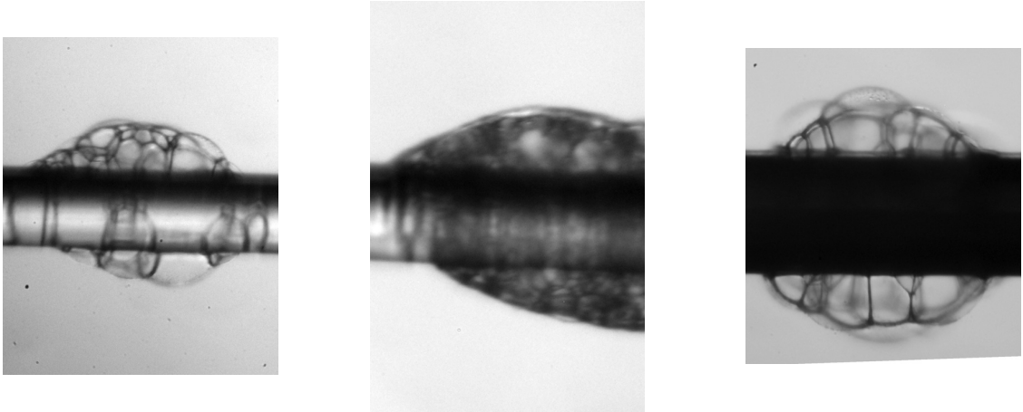
FIGURE D.5 – Photographie des paquets émis lors de l'enduction d'une fibre de Nylon. De gauche à droite : V = 40 mm/s et b = 40 \mu\text{m} , V = 200 mm/s et b = 40 \mu\text{m} , V = 100 mm/s et b = 75 \mu\text{m} .
