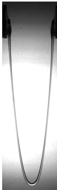
FIGURE 7.15 – À gauche : chaînette visqueuse d'huile silicone ( \eta = 9,7 \text{ Pa} \cdot \text{s} , L = 24 \text{ mm} et D = 2,3 \text{ mm} ), aux grandes déformations. À droite : on superpose à la forme de ce filament visqueux (en gris) la forme d'une chaînette (pointillés noirs) ayant les mêmes dimensions (les axes sont en centimètres).
