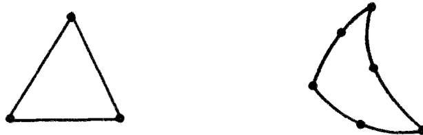
Fig. II-3-1. Triangles à côtés droits (2 points/face) et paraboliques (3 points/face)
