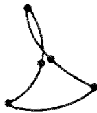
Fig. II-3-7. Exemple de transformation conduisant à un jacobien nul ou négatif
