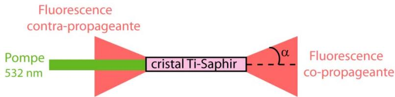
Figure III.20 : Emission de fluorescence d'un cristal de Ti-Saphir avec guidage par réflexion totale interne.
