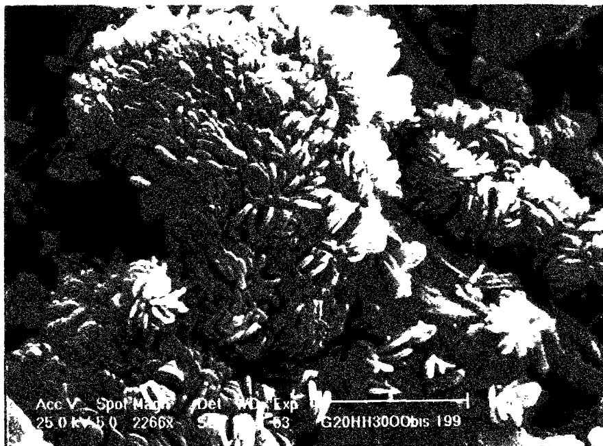
Photo VII. 3 : Produits d'alcali-réaction en plaquettes sur une fracture de granulats (G : x 2 266)
