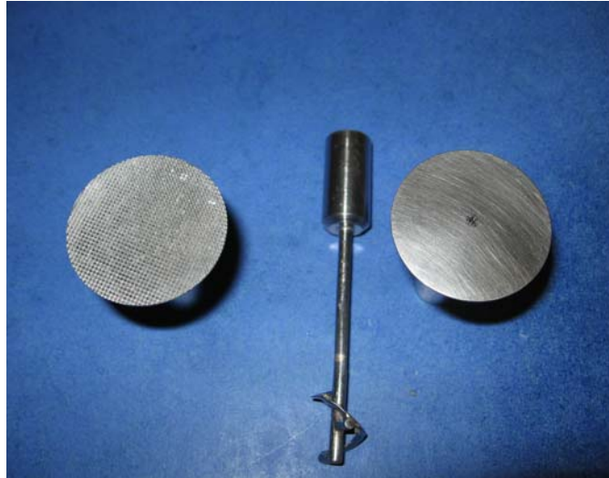
Figure 42 : Photographie des trois géométries utilisées en rhéométrie.
