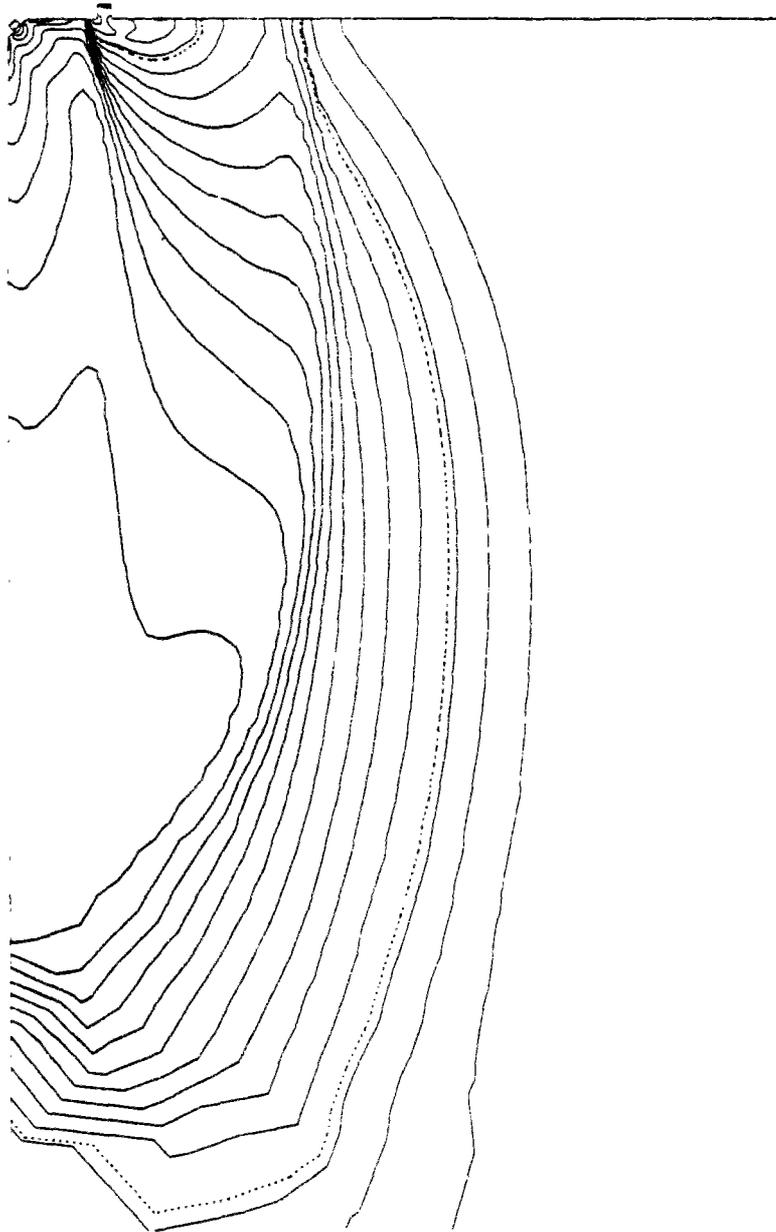
Figure IV.20 : Lignes Isomach - Calcul avec combustion
