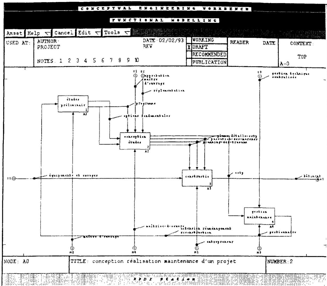
Fig S3.6. Processus de production d'un projet de construction.
