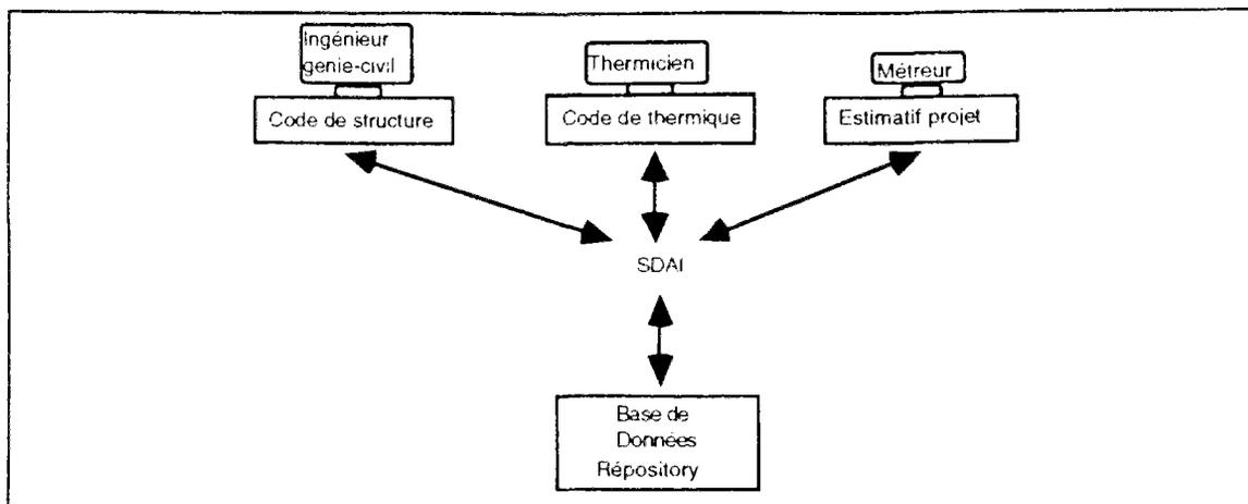
Fig S6.3. Échange par requêtes standardisées dans un "repository"
