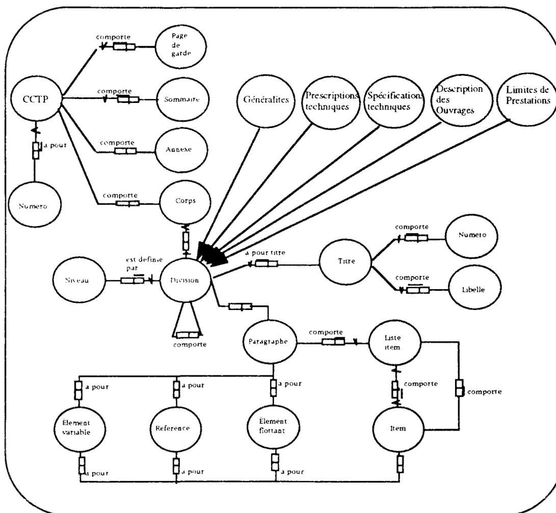
Fig S4.11. Structure d'un CCTP.
