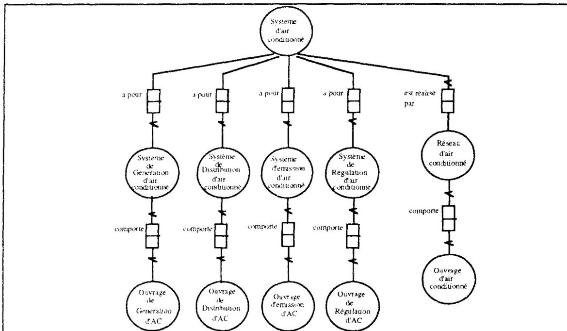
Fig S3.28. Le système d'air conditionné
