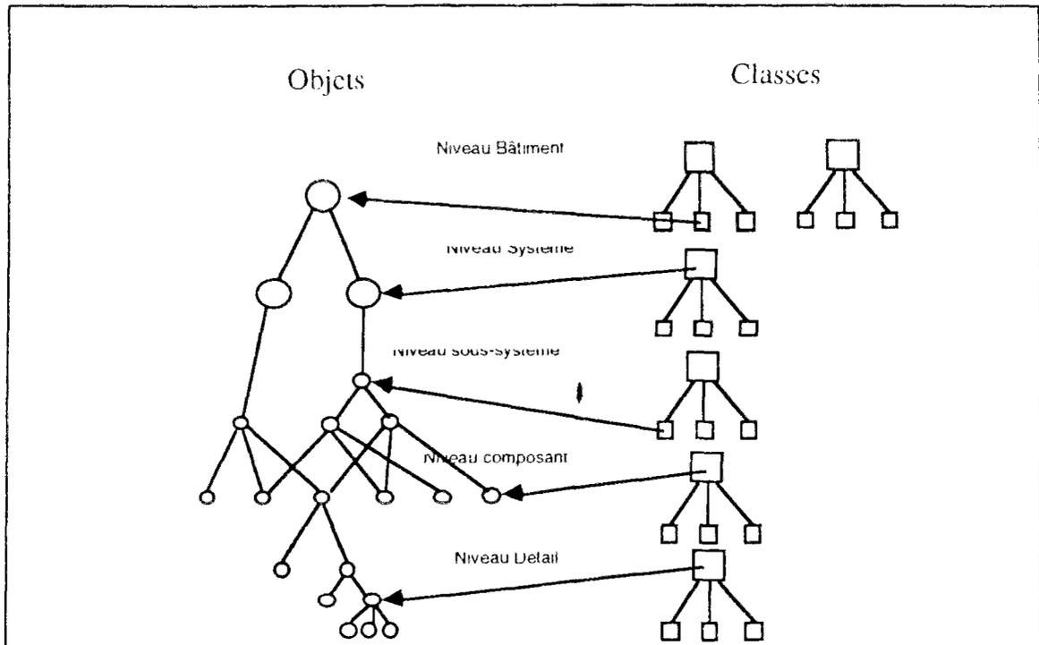
Fig S2.9. les divers niveaux du modèle RATAS
