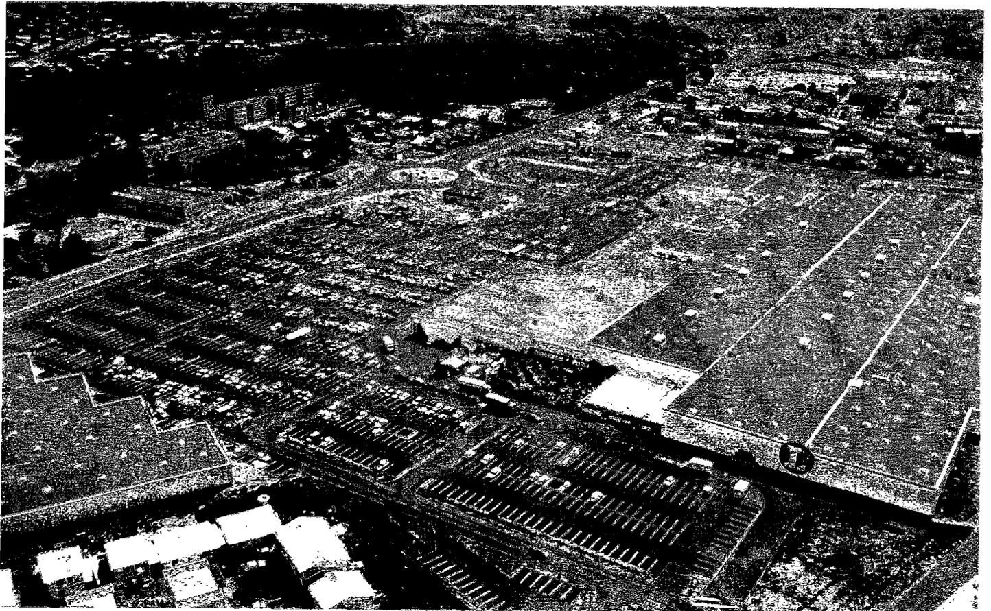
*Figure 5.41. : Vue aérienne du centre commercial Leclerc de Saint Médard en Jalles (Gironde) et de son parking à structure réservoir.*
