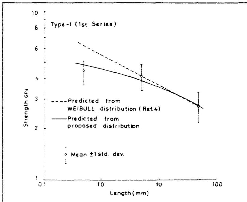
Fig. 1.1 : Résistance d'une fibre en fonction de sa longueur
