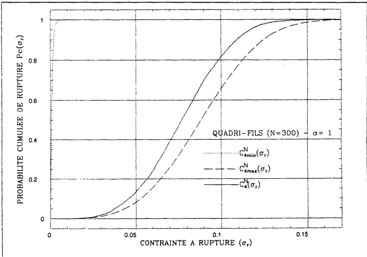
Fig. 5.2 : Probabilités cumulées de rupture du quadri-fil ( $\alpha=1$ )
