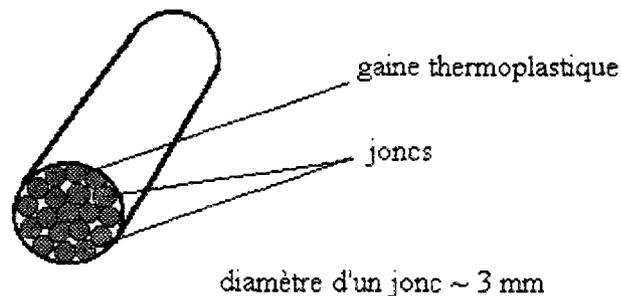
Les joncs sont composés de fibres unidirectionnelles (verre, carbone). Ce sont donc des composites unidirectionnels, obtenus en général par pultrusion.
