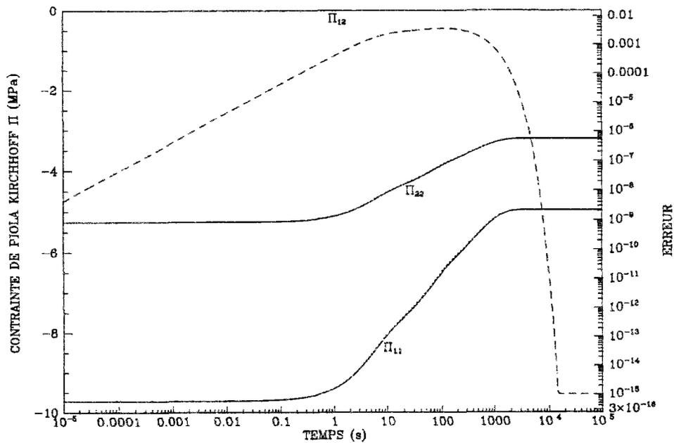
FIG. C.3 - *Chargement C: Contrainte de Piola-Kirchhoff et erreur sur le potentiel*
