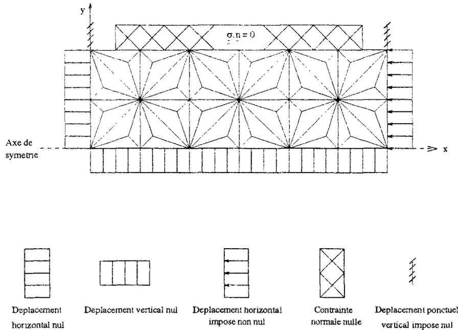
FIG. 4.12 - Conditions de sollicitation d'un cylindre en compression à section constante
