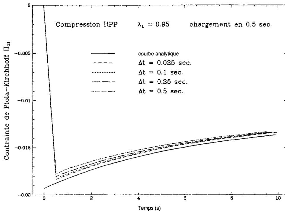
FIG. 4.3 - *Contraite uniaxiale homogène pour un chargement quasi-instantané*
