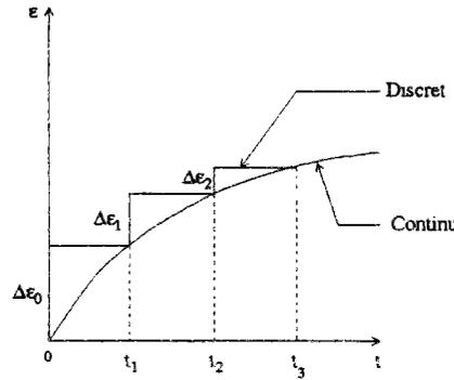
FIG. 2.8 - Déformation imposée discrète et continue
