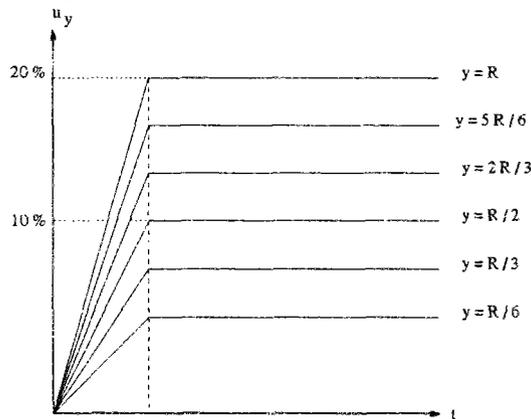
FIG. 4.15 - Déplacement vertical imposé sur le bord droit
