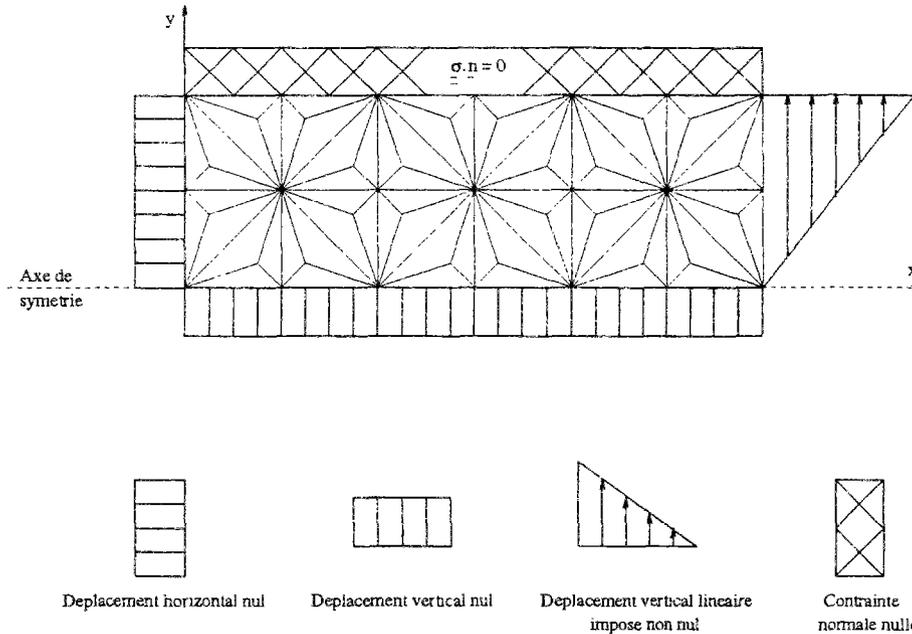
FIG. 4.14 - Conditions de sollicitation d'un cylindre en cisaillement
