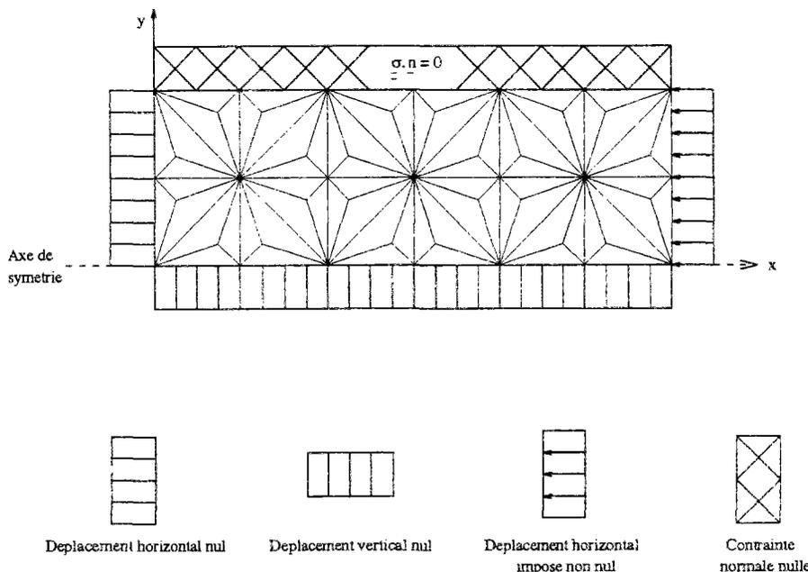
FIG. 4.2 - Conditions de sollicitation d'un cylindre en compression
