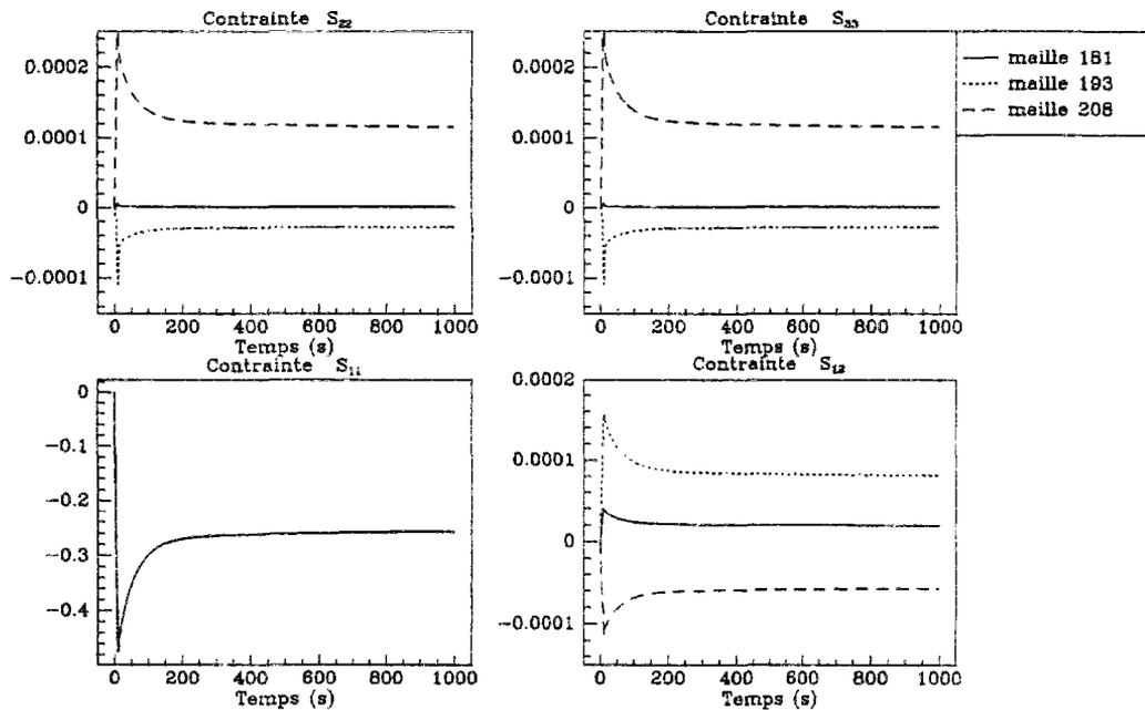
FIG. 4.10 - Evolution de la contrainte pour un comportement viscoélastique avec:  $\underline{\underline{\mathbb{E}}} = a_0 \underline{\underline{\mathbb{1}}} + a_1 \underline{\underline{\Delta}}$ ,  $\Delta t = 1 \text{ sec.}$ ,  $t_c = 10 \text{ sec.}$
