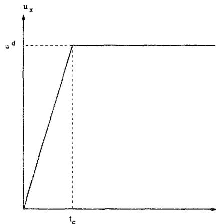
FIG. 4.1 - Déplacement horizontal imposé sur le bord droit
