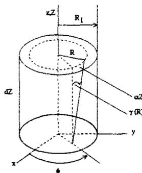
FIG. 2.12 - Essai de torsion d'un cylindre
