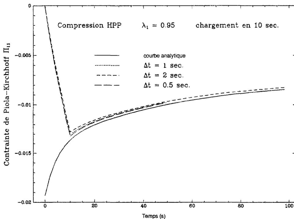
FIG. 4.4 - *Contraite uniaxiale homogène pour un chargement lent*
