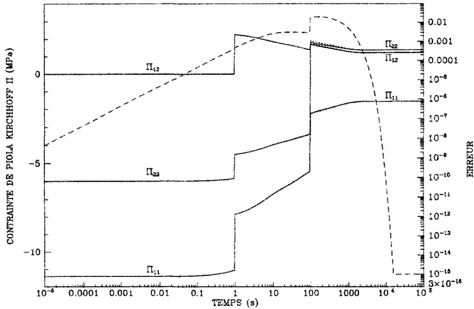
FIG. C.7 - *Chargement H: Contrainte de Piola-Kirchhoff et erreur sur le potentiel*
