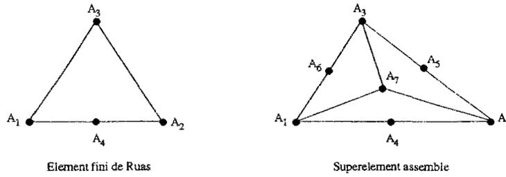
FIG. 3.2 - *Elément fini utilisé [Ruas, 1981]*
