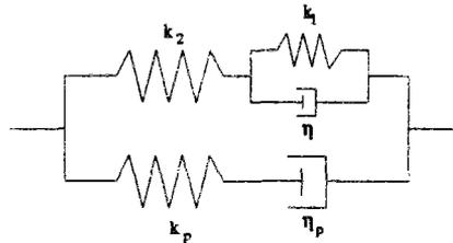
FIG. 2.13 - Le modèle à cinq paramètres
