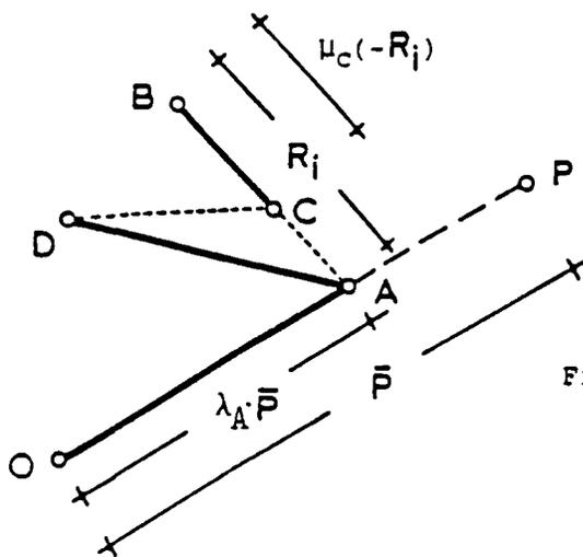
Fig.III.31. Stratégie de résolution proposée; trajet de chargement correspondant à la fissuration d'un élément et la redistribution des efforts libérés
