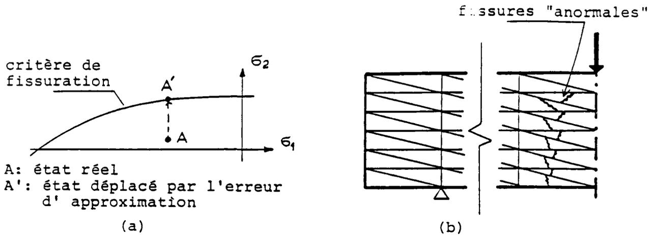
Fig.V.1. Effets de l'erreur d'approximation due à l'élément triangulaire utilisé
