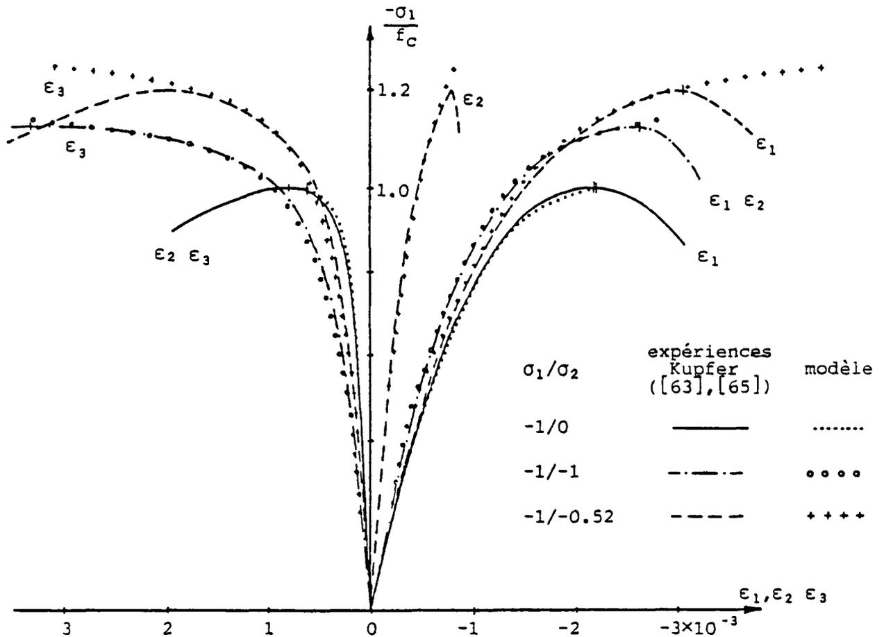
Fig. III.9. Loi de comportement du béton : prévisions du modèle et comparaison avec les résultats expérimentaux
