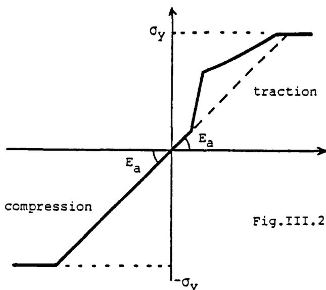
Fig.III.25. Plastification de l'acier
