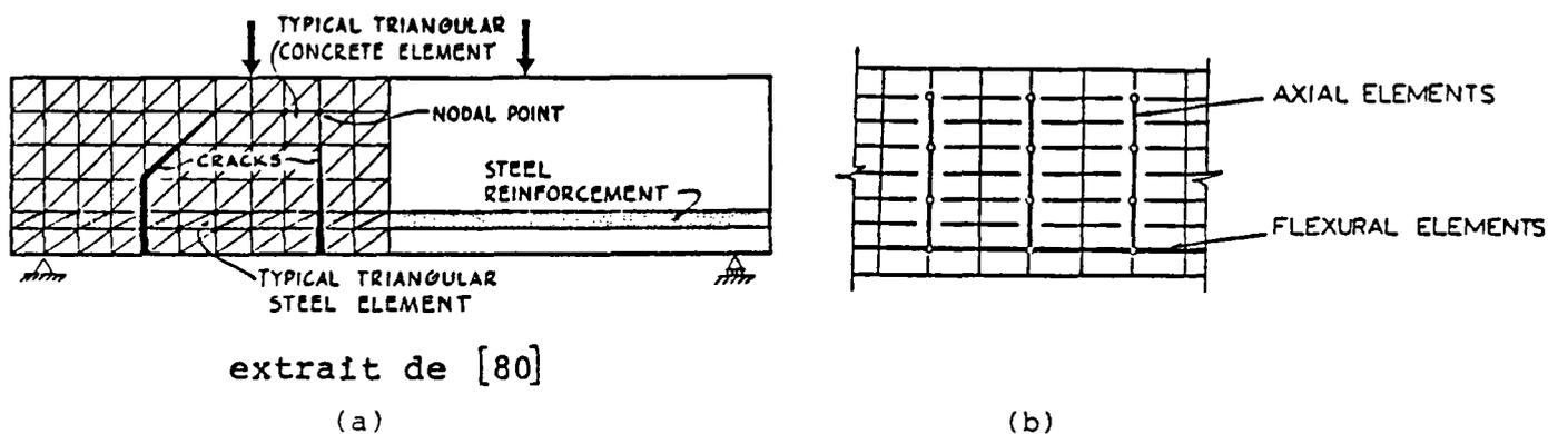
Fig. II.1 Schématisation "discrète" des armatures.
