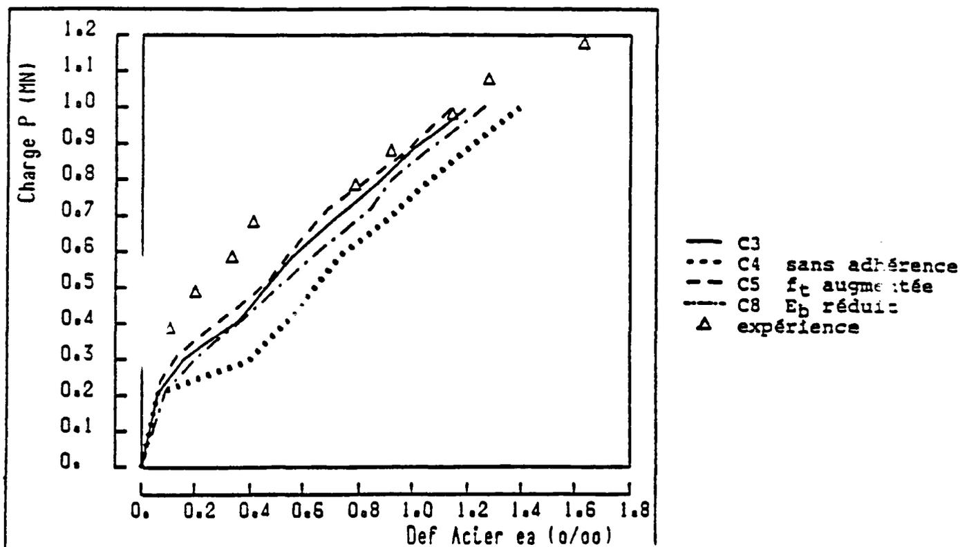
Fig. V.15 Déformations de l'acier à mi-travée; panneau WT3.
