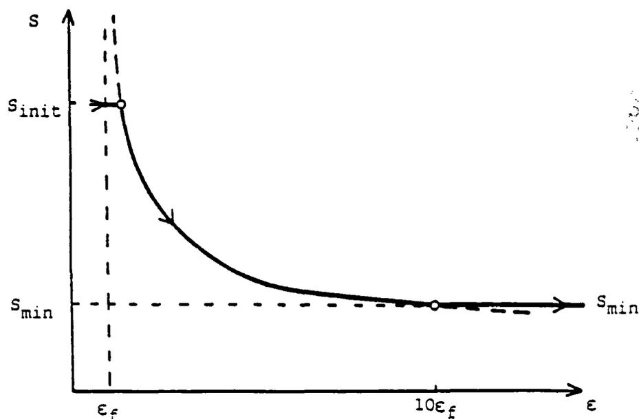
Fig.III.26. Evolution de l'espaceur des fissures
