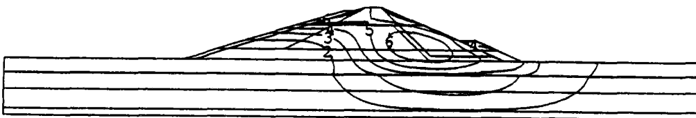
Fig. 5.37 Courbes d'isovaleurs de déplacements horizontaux au temps t = 709j (1 mois environ de mise en service)
