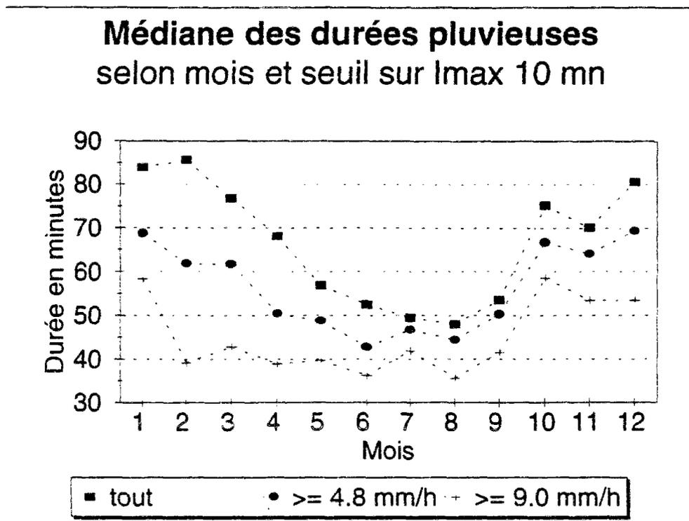
**Figure 26 :** Evolution mensuelle de la médiane des durées de séquences pluvieuses selon 3 seuils d'intensité maximale en 10 minutes : 0, 4.8 mm/h (T=1 sem.) et 9.0 mm/h (T=2sem.). Série régionale de 7 postes de Seine-Saint-Denis 1976-1992.
