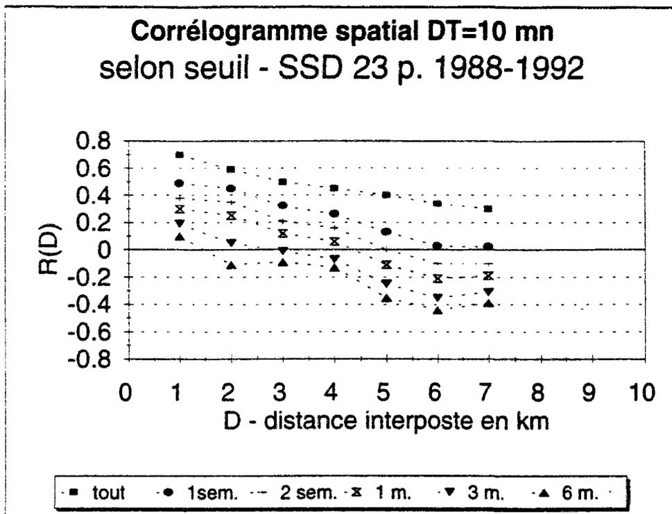
Figure 40 : Effet du seuil (exprimé en fonction de sa période de retour) sur les corrélogrammes.
