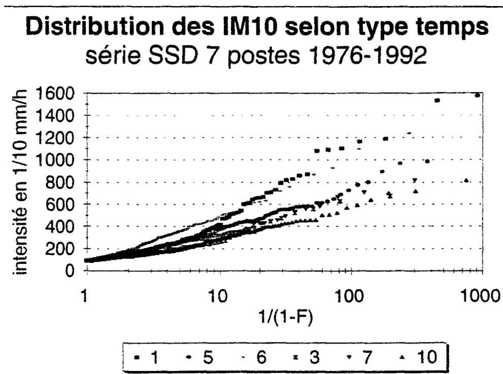
**Figure 24 :** Distributions empiriques des séries régionales d'intensités maximales selon les différents types de temps, sauf les types d'hiver (2, 4, 8 et 9). Série de 7 postes de Seine-Saint-Denis 1976-1992.
