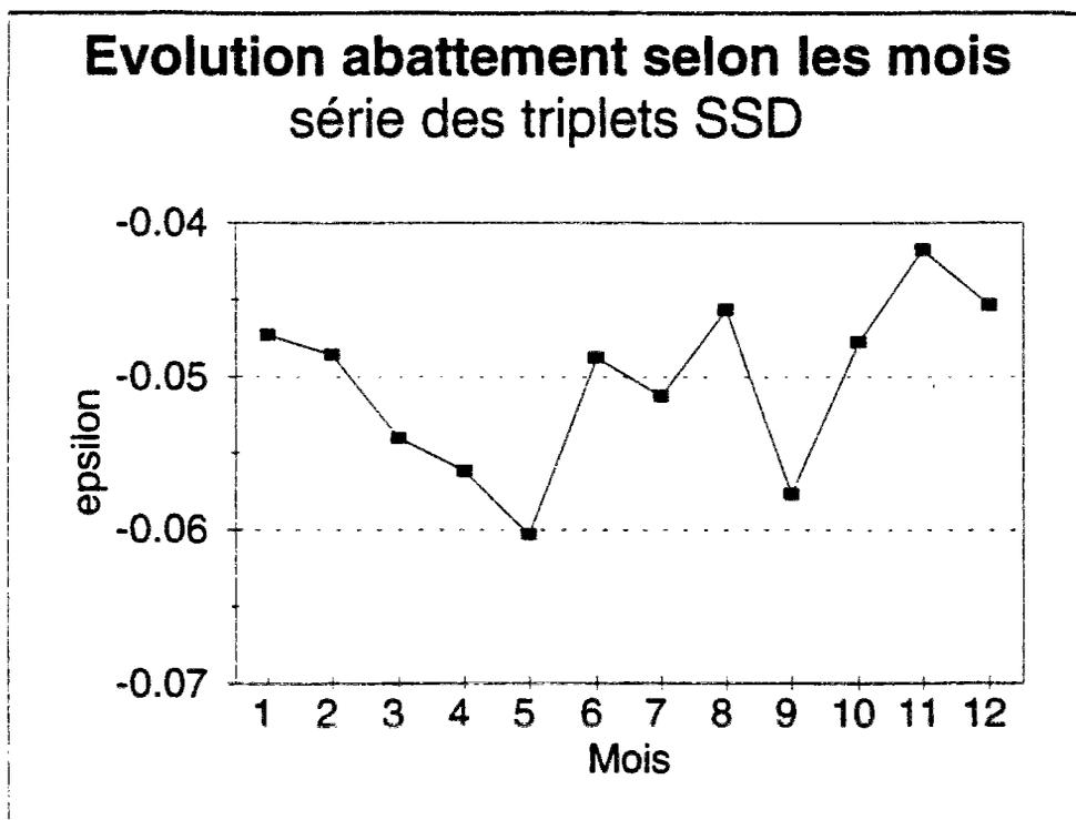
**Figure 48 :** Evolution du paramètre  $\epsilon$  du modèle d'abattement  $S^{**}(-\epsilon + \delta \cdot \text{Ln}(\Delta t))$  en fonction du mois de l'année.
