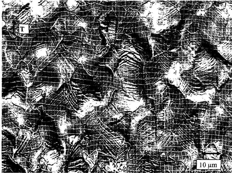
Figure III.10 : une grille de l'essai T, à 28% de déformation
