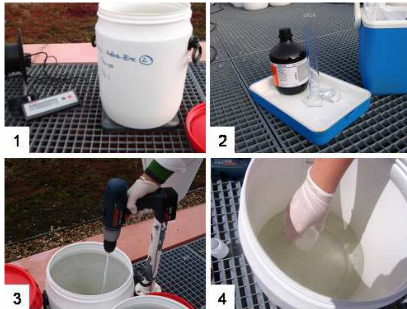
Figure 35 : Procédure d'échantillonnage, 1 : pesée des bidons, 2 : acidification, 3 : homogénéisation, 4 : échantillonnage
