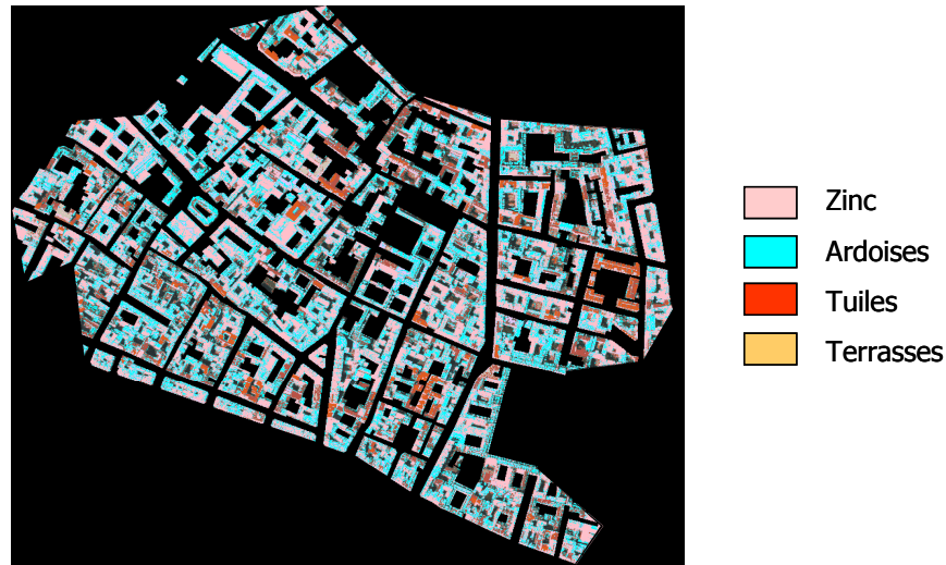
Figure 114 : Classification des toits réalisée par Erdas
