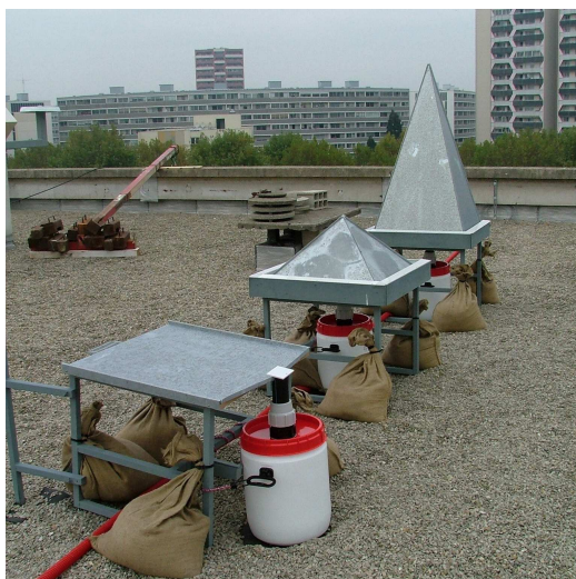
Figure 90 : Photographie du carré et des pyramides en zinc naturel neuf
