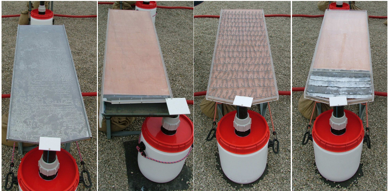
Figure 32 : Photos des différents types de maquettes exposées, de gauche à droite : panneau, gouttière, crochets de fixation, éléments d'étanchéité en plomb.
