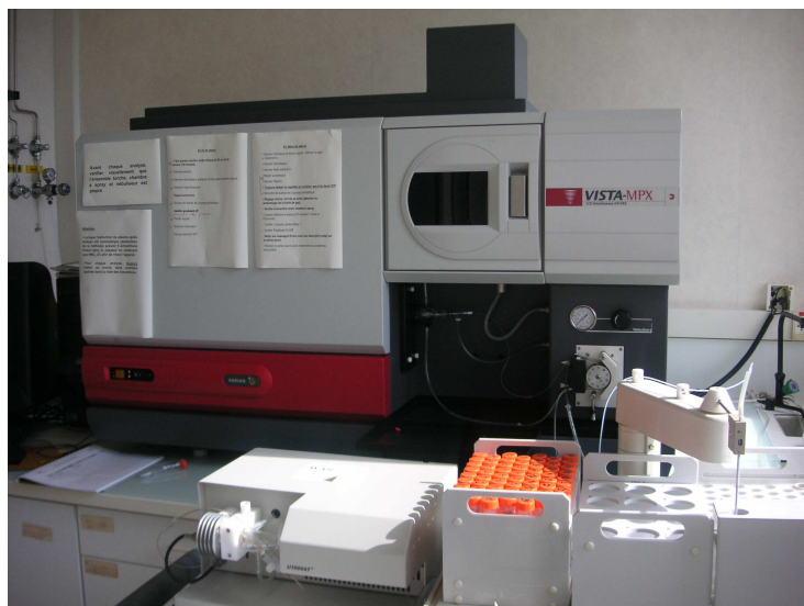
Figure 38 : Photographie de l'ICP-AES Vista MPX Varian, utilisé pour les analyses de métaux
