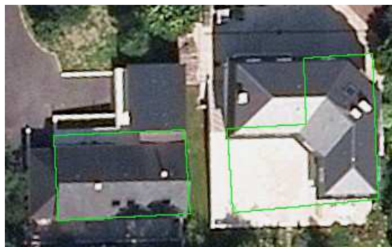
Figure 112 : Illustration du problème d'actualité des données entre BD-Topo et orthophotographie
