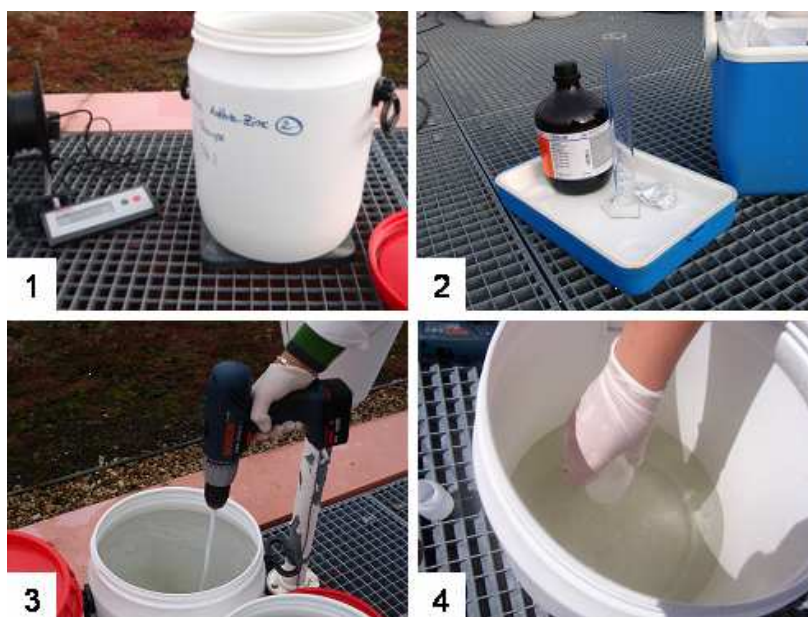
Figure 35 : Procédure d'échantillonnage, 1 : pesée des bidons, 2 : acidification, 3 : homogénéisation, 4 : échantillonnage
