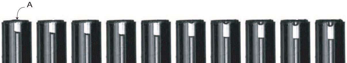
Fig. 1.34- Série d'images à 7500 i/s. Le passage de l'interface haute (A) à travers l'entrée du tube ralentit le liquide.
