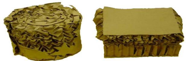
Figure 2.21 – Étude sur les capacités d'absorption des chocs réalisée par Basily and Elsayed (2004b)
