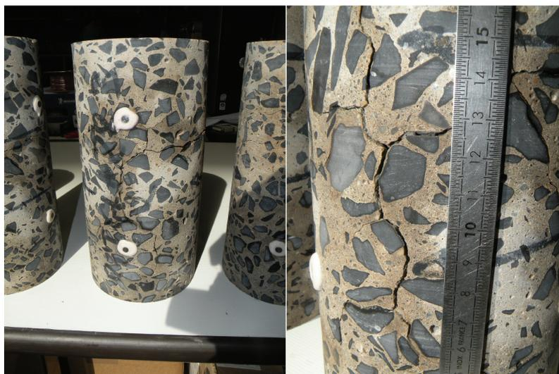
Figure 3-22 : fissuration des éprouvettes R2\_GLA après 130 jours d'exposition
