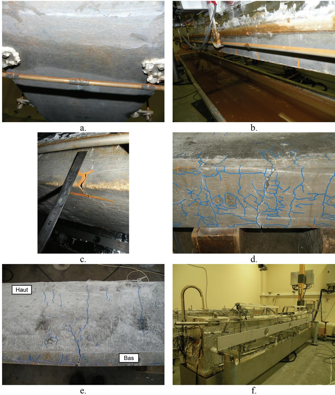
**Figure 4-41 : fissuration de la poutre P2**
