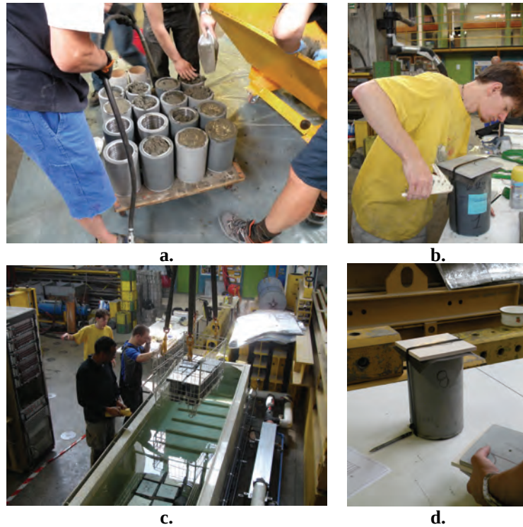
Figure 2-65 : fabrication d'éprouvettes de gonflement sous contraintes a. coulage d'éprouvettes b. protection vis-à-vis de la lixiviation c. cure d'éprouvettes d. éprouvette équipée pour la cure
