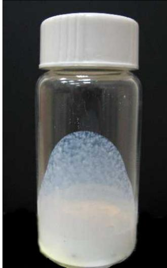
**Figure 29 - Observation de floc par démoillage sur les bords du pilulier**
