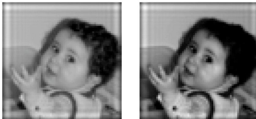
Figure 2.9 : Restitution d'une image d'amplitude pure avec les réglages optimisés (voir texte) ; à gauche avec l'approche de Denisyuk, à droite avec celle de Lippmann.
