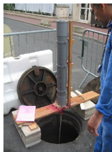
(c) Système d'injection du sel
