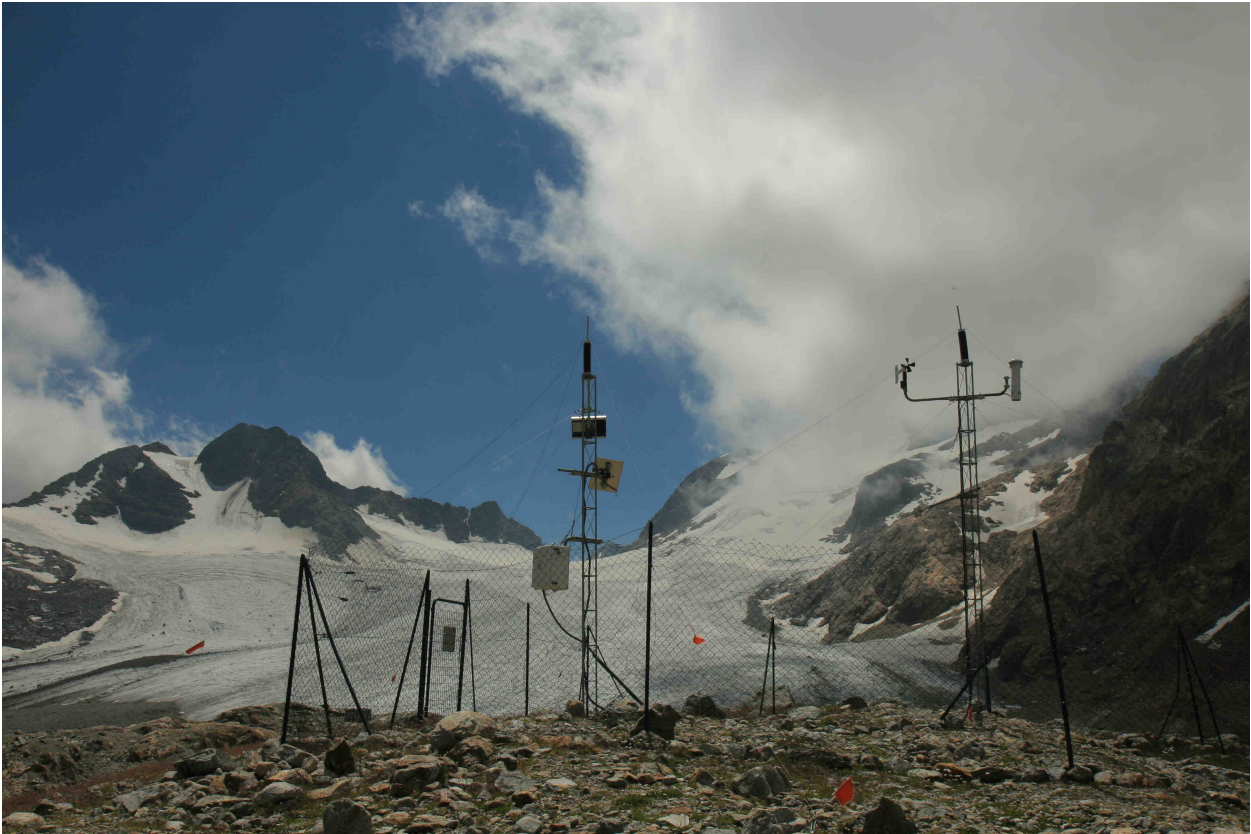
FIGURE D.1: Station météorologique automatique sur la moraine du glacier de Saint Sorlin. L'incertitude sur la mesure de température est de \pm 0.1^{\circ}\text{C} , sur l'humidité relative de \pm 1.5\% , sur la vitesse du vent \pm 0.3\text{ m s}^{-1} , et sur les mesures de rayonnement, \pm 3\% des flux. Incertitudes de mesures données par les constructeurs. Cliché : B. Jourdain
