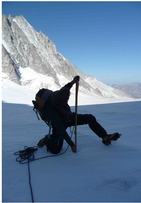
FIGURE 1.2: Mesure d'une balise d'accumulation sur le glacier d'Argentière, massif du Mont Blanc. Cliché : M. Dumont
