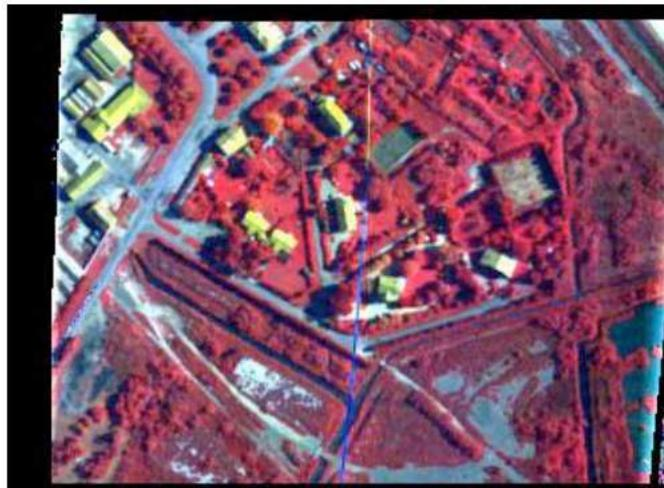
**Fig. 1.9** – Exemple d'image spectrale reconstruite à partir des acquisitions du démonstrateur de spectro-imagerie par transformée de Fourier statique grande étendue CaHyD. Les résultats sont représentés en fausses couleurs
