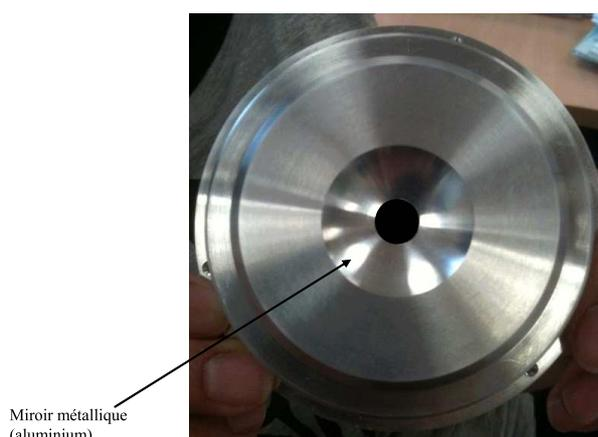
**Fig. 8.2** – Vue coté détecteur du miroir de réduction de flux de structure.
