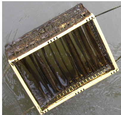
Figure 22 : Cagette en plastique et membranes LDPE recouvertes de périphyton sur le site de Saint-Maurice.
