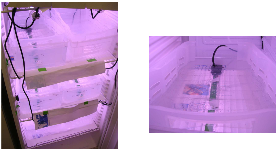
Figure 43 : Armoire thermostatée contenant les bacs d'exposition (à gauche) et bac d'exposition rempli avec son système d'agitation (pompe à eau et tuyau en plastique percé sur la longueur pour répartir le flux d'eau).
