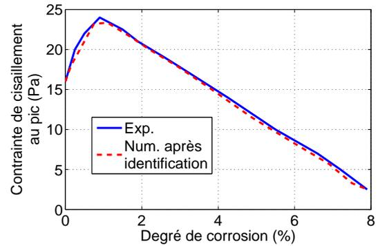
FIG. 3.3 – Comparaison de la réponse du modèle avec l'expérience après identification.
