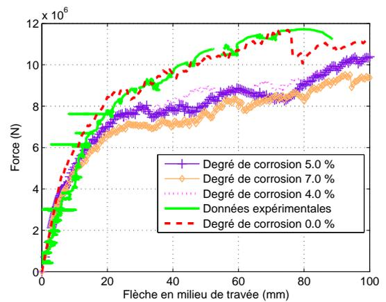
FIG. 4.78 – Effets d'une réduction locale de l'adhérence acier/béton.
