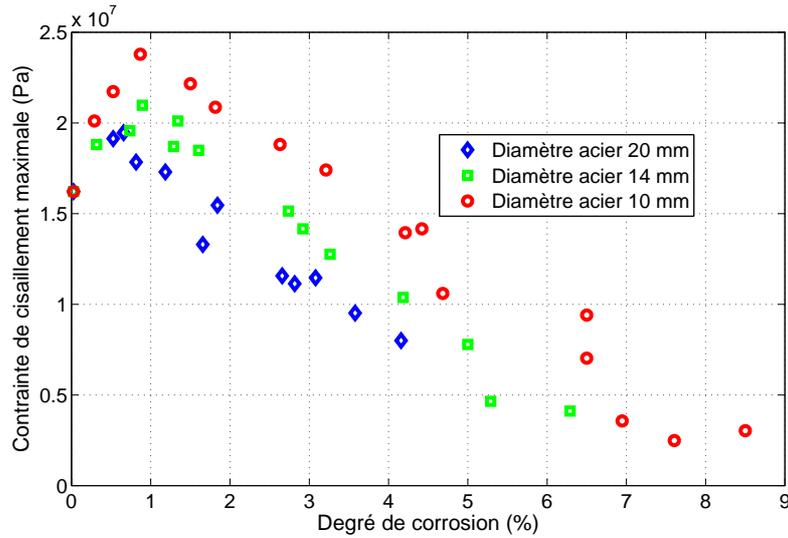
FIG. 2.3 – Réponses des essais d’arrachement réalisés sur des éprouvettes corrodées à différents degrés définis en perte de masse (d’après (Sulaimani *et al.*, 1990)).
