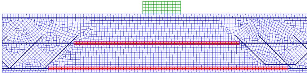
FIG. 4.76 – Maillage du pont d'Örnsköldsvik modifié par la mise en place d'éléments joints.
