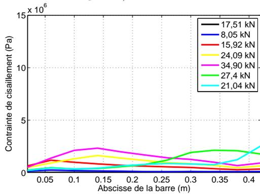
FIG. 4.56 – Contrainte de cisaillement le long de la barre  $T_c = 7,50$  %.
