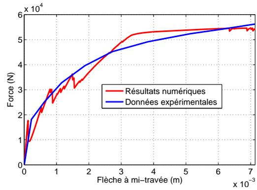
FIG. 4.41 – Courbe force/déplacement  $T_c = 2,50\%$ .
