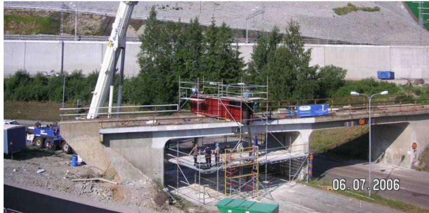
FIG. 4.66 – Montage de chargement du pont d'Örnköldsvik.
