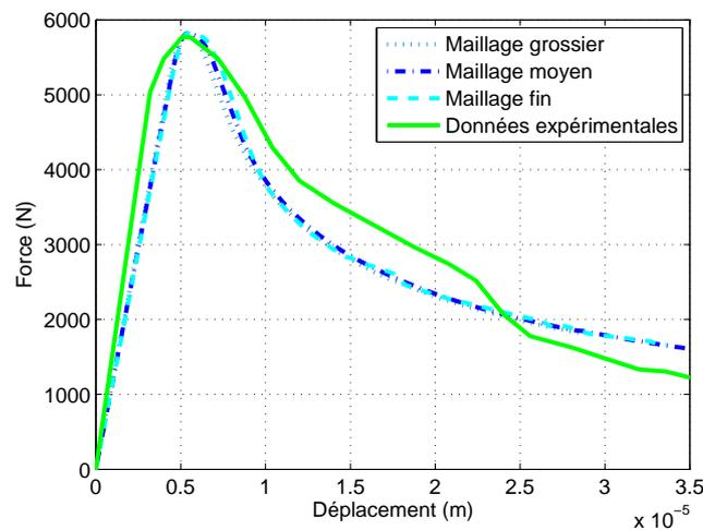
FIG. 4.20 – Courbes expérimentale et numériques force/déplacement.
