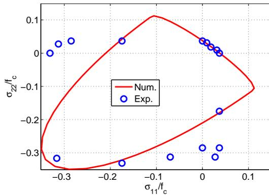
FIG. 3.16 – Surfaces d'élasticité numérique et expérimentale.
