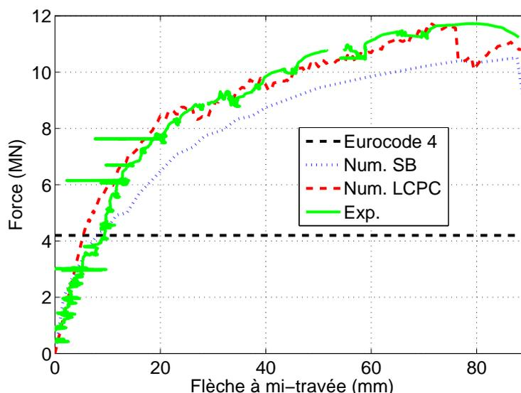
FIG. 4.68 – Courbe force/flèche obtenue numériquement et comparaison avec les données expérimentales.
