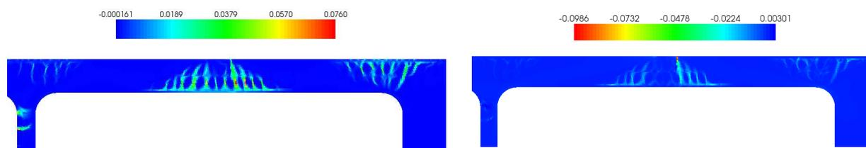
FIG. 4.72 – Distribution du champ de déformation selon la direction principale 1 à rupture.
