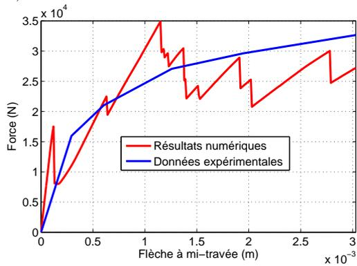
FIG. 4.44 – Courbe force/déplacement  $T_c = 7,50\%$ .
