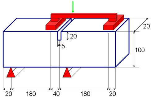
FIG. 4.11 – Poutre simplement entaillée soumise à un chargement de cisaillement asymétrique - toutes les dimensions sont données en millimètres.
