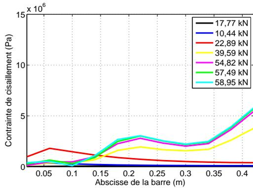
FIG. 4.38 – Contraintes de cisaillement à l'interface le long de la barre de renforcement obtenues pour la poutre saine.
