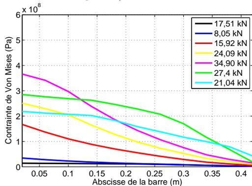
FIG. 4.50 – Contrainte de Von Mises le long de la barre  $T_c = 7,50\%$ .
