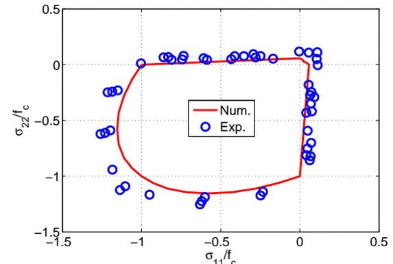
FIG. 3.17 – Surfaces de rupture numérique et expérimentale.
