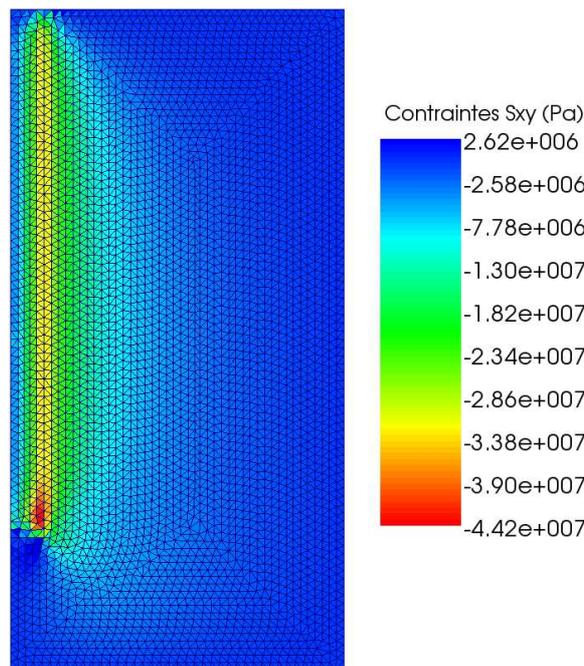
FIG. 4.3 – Contraintes de cisailment au pic de résistance pour un confinement de 0 MPa.
