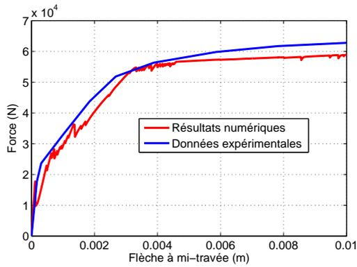
FIG. 4.36 – Courbe force/déplacement obtenue pour la poutre saine.
