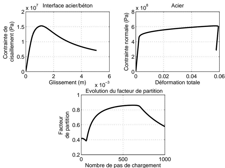
FIG. 3.19 – Résultats locaux - sans corrosion monotone
