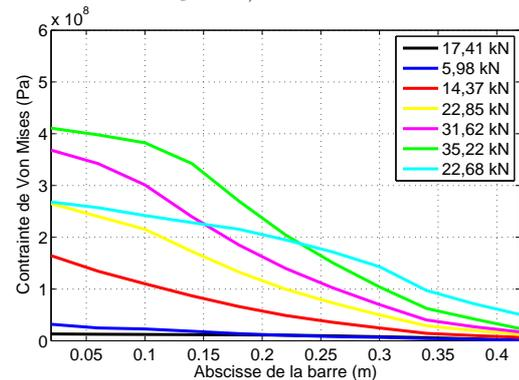
FIG. 4.51 – Contrainte de Von Mises le long de la barre  $T_c = 10,00\%$ .
