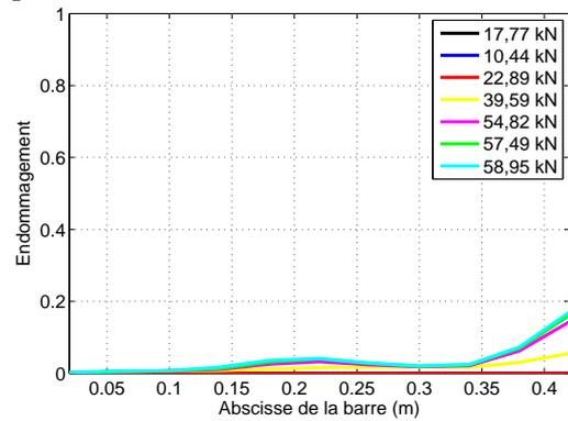
FIG. 4.39 – Endommagement à l'interface le long de la barre de renforcement obtenu pour la poutre saine.
