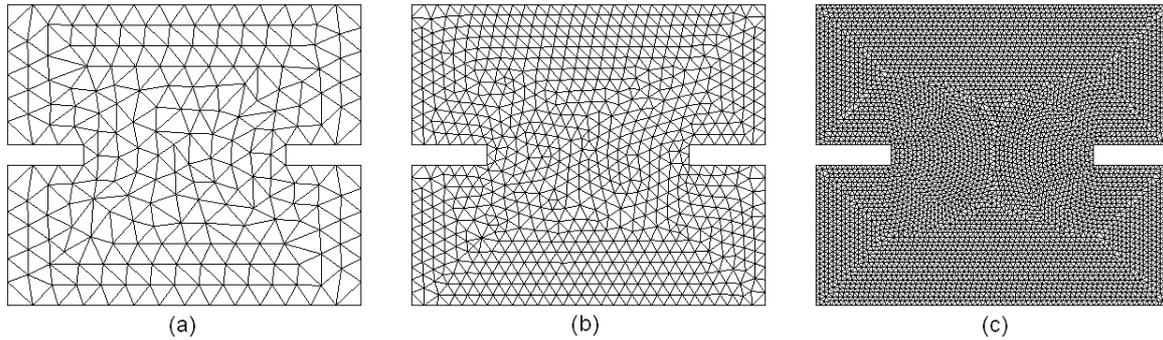
FIG. 4.19 – Maillages utilisés pour les simulations - (a) 400 éléments, (b) 1500 éléments et (c) 9492 éléments.
