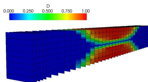
FIG. 4.29 – Cartographie d'endommagement obtenue pour la poutre testée par (LaBorderie, 1991) - approche simplifiée.
