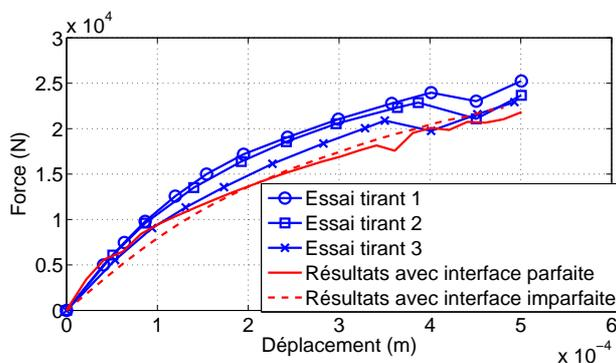
FIG. 4.6 – Courbes force/déplacement obtenues pour les différents niveaux de confinement.
