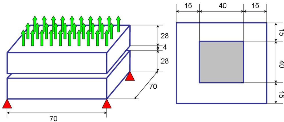
FIG. 4.18 – Schéma de l’essai réalisé par (Hassanzadeh, 1991).
