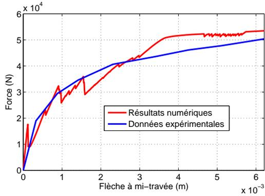
FIG. 4.42 – Courbe force/déplacement  $T_c = 3,75\%$ .
