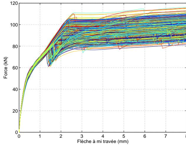
FIG. 4.25 – Courbes de réaction à rupture - 15000 tirages.
