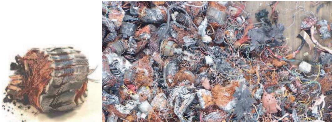
Figure 29 : Moteur électriques broyés (Source BAUDELET)
